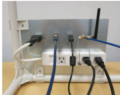
シールドテント貫通線端子板例 上段左からAC、LAN、USB、2xSMA 下段は4口ACタップ
